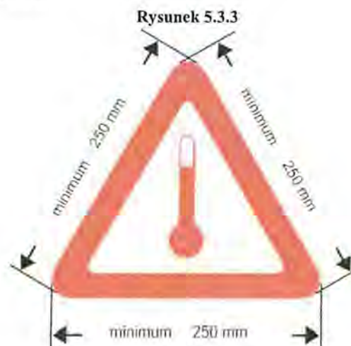
Znak stosowany przy przewożeniu materiałów o podwyższonej temperaturze
